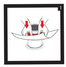
Stülpen Sie die HOTSchott Manschette gleichmäßig über den abzudichtenden Durchbruch und das doppelwandige Abgasrohr.
