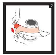
Entfernen Sie den ersten Teil der hinten liegenden Schutzfolie des Klebekragens.
