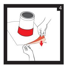
Entfernen Sie den unteren Teil der Schutzfolie.
