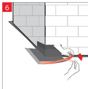
6 Entfernen Sie den ersten Teil der unterliegenden Schutzfolie des Klebekragens.
