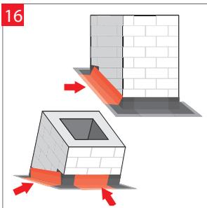
Das Anschlussband muss an allen vier Seiten nach dem gleichen Prinzip verbaut werden. Bitte achten Sie speziell bei Dachschrägen auf die erforderliche Überlappung von mindesten 3 cm.
