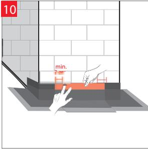
Der Klebekragen wird mindestens 3 cm überlappend an der WinkelECK Manschette und an dem Bauteil befestigt.
