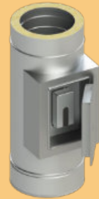
Prüföffnung Festbrennstoff mit Rußschutztür 12/18 nur für Innenbereich (bis DN 250)
