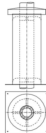
Bild 12: Aufbau Stulprohr mit integrierter Abluftführung
