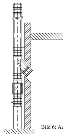
Bild 6: Aufbau mit Teleskopstütze
