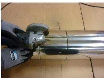
Führen Sie nun einen Längsschnitt im Außenrohr vom Rohrende bis zur Schnittkante durch.
